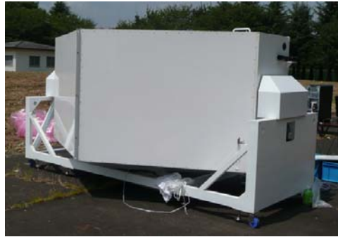
横向き観測のKaレーダ (左:受信、右:送信アンテナ)
